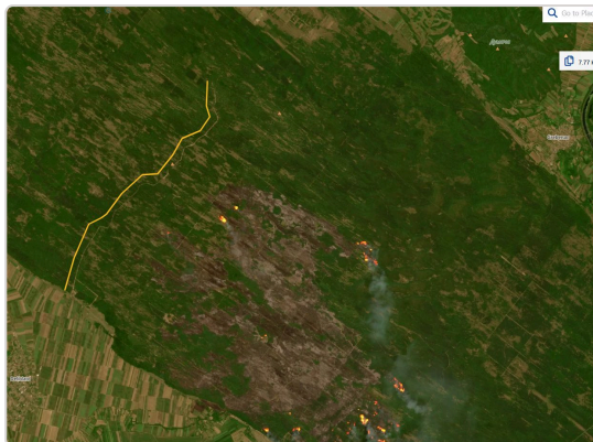
Слика 2 — ИЗВЕДЕНО (потврђено са терена): пут испод просеке 17 проширен лево и десно (~7,6 km) — цела западна линија линије одбране; просека 17 ван препорука.
